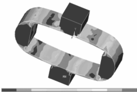
图 2 放大机构的应力场分布图
